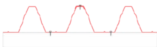
KROVNO PROFILISANJE PRESEK MONTAŽE
